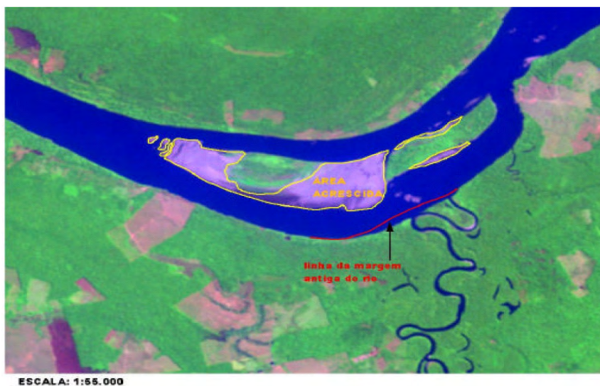
FIGURA B.IV. 11 – Imagem de satélite (08/2000) mostrando, na linha vermelha, o limite da margem antiga do rio Madeira e, também, o seccionamento do canal do rio Jaci pelo rio Madeira.
